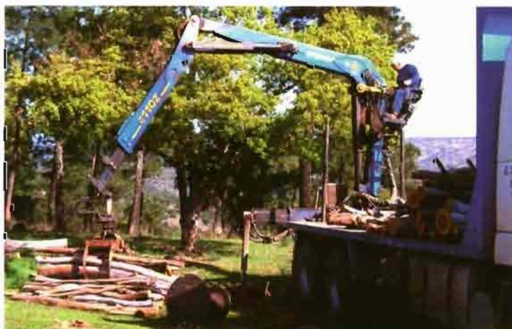
Foto 2. Carga de madera en camión. Esta operación puede ocasionar, principalmente, golpes por las trozas o por la grúa.
