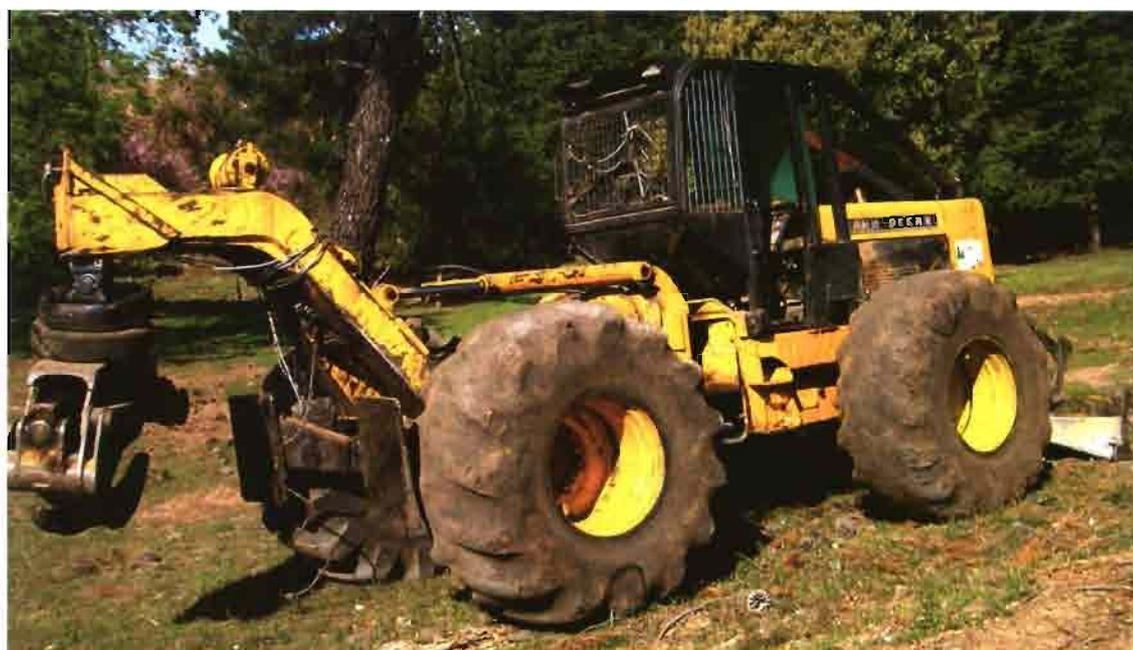
**Foto 1. Tractor forestal utilizado para la saca de madera, mediante arrastre y/o transporte con pinza.**
