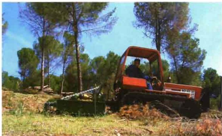
Foto 3 (izda.). Eliminación de restos de corta con desbrozadora de cadenas. El trabajo de la desbrozadora proyecta partículas y objetos (piedras, restos forestales, trozos de cadena) que pueden golpear a trabajadores que no guardan la obligada distancia de seguridad con la máquina.
