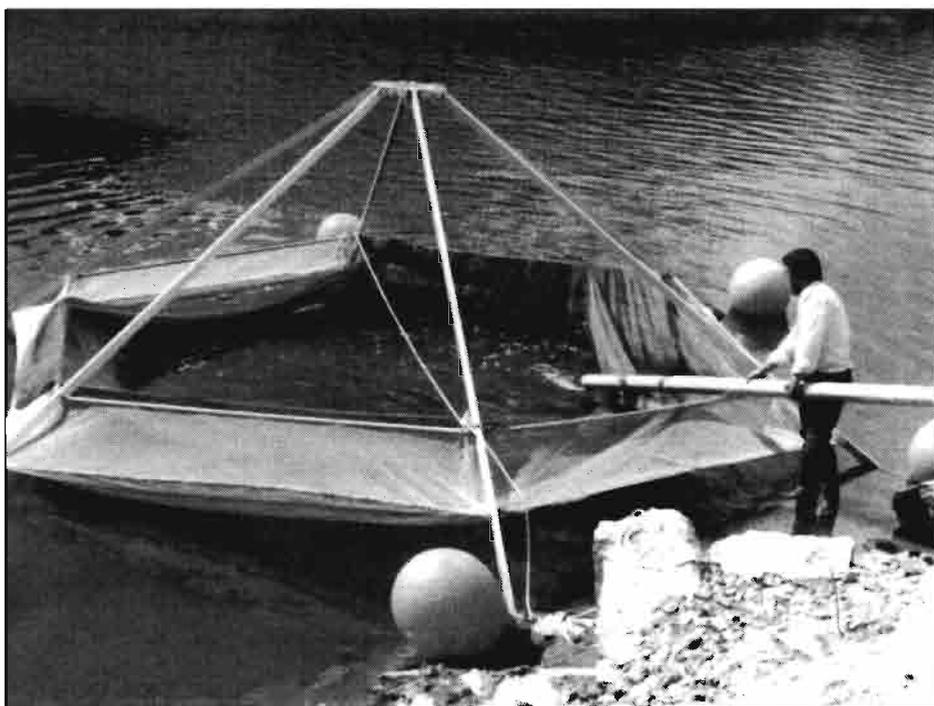
*Los tripodes flotantes patentados, son plegables al estilo de un paraguas, y fácilmente transportables (70 kg de peso total). Una embarcación puede penetrar fácilmente en el interior del tripode, para manipularlo fácilmente mediante una polea situada en el vértice del mismo. Es preciso regular la profundidad de inmersión de los cilindros con el fin de optimizar la temperatura y oxigenación del agua, así como la luminosidad, riqueza del zooplancton y fitoplancton.*
