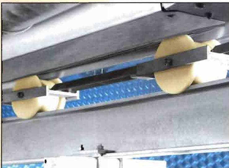
Fig. 8.- Tren de ruedas deslizantes en una moderna rotativa.
