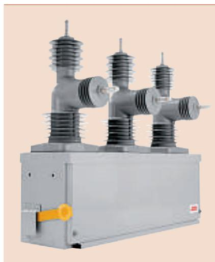
operación muy frecuentes. 100.000 operaciones hasta el final de su vida útil. Está disponible para el rango de 12–24 kV y corrientes de cortocircuito de hasta 50 kA y puede integrarse con aparamenta aislada por aire.
