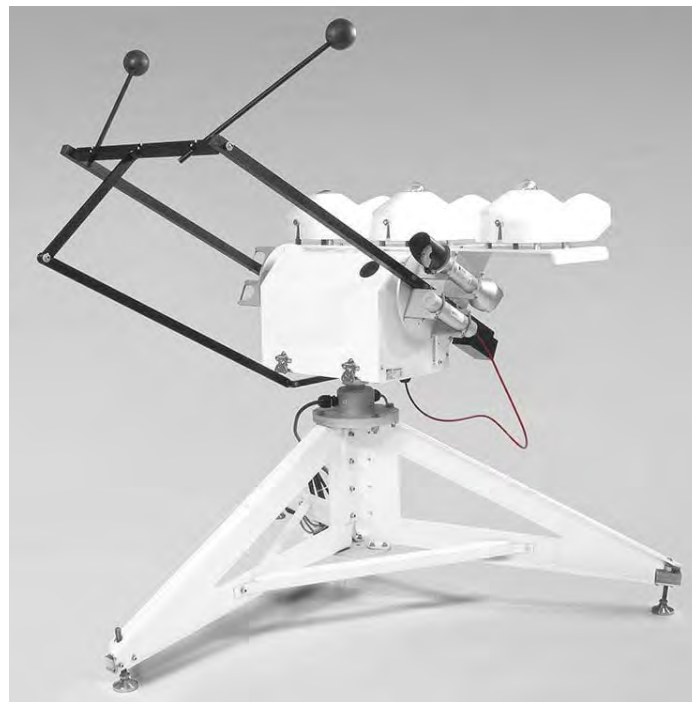
Figura 2-8 Equipo medición solar Kipp&Zonen©
