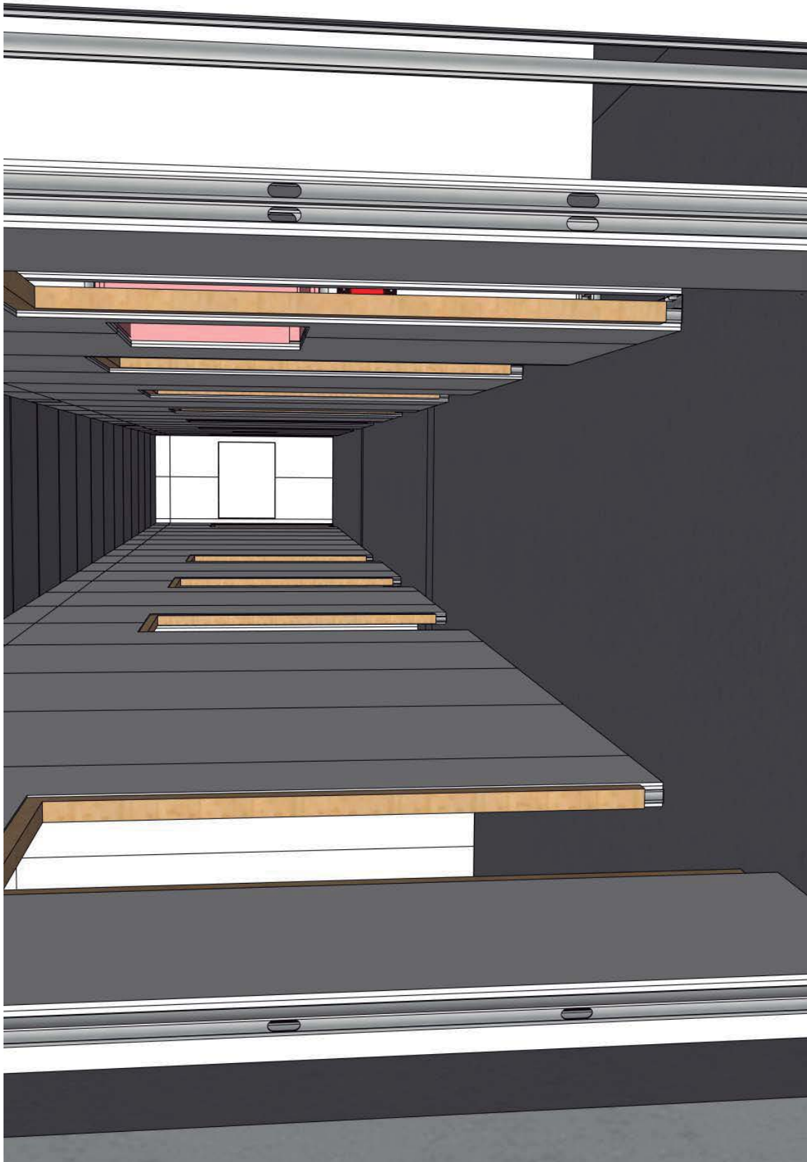
Fig. 45 – Tabiquería de pladur, con la carpintería de madera. Se observa, en la zona destinada a una BIE, el color rosa del pladur (protección contra el fuego)
