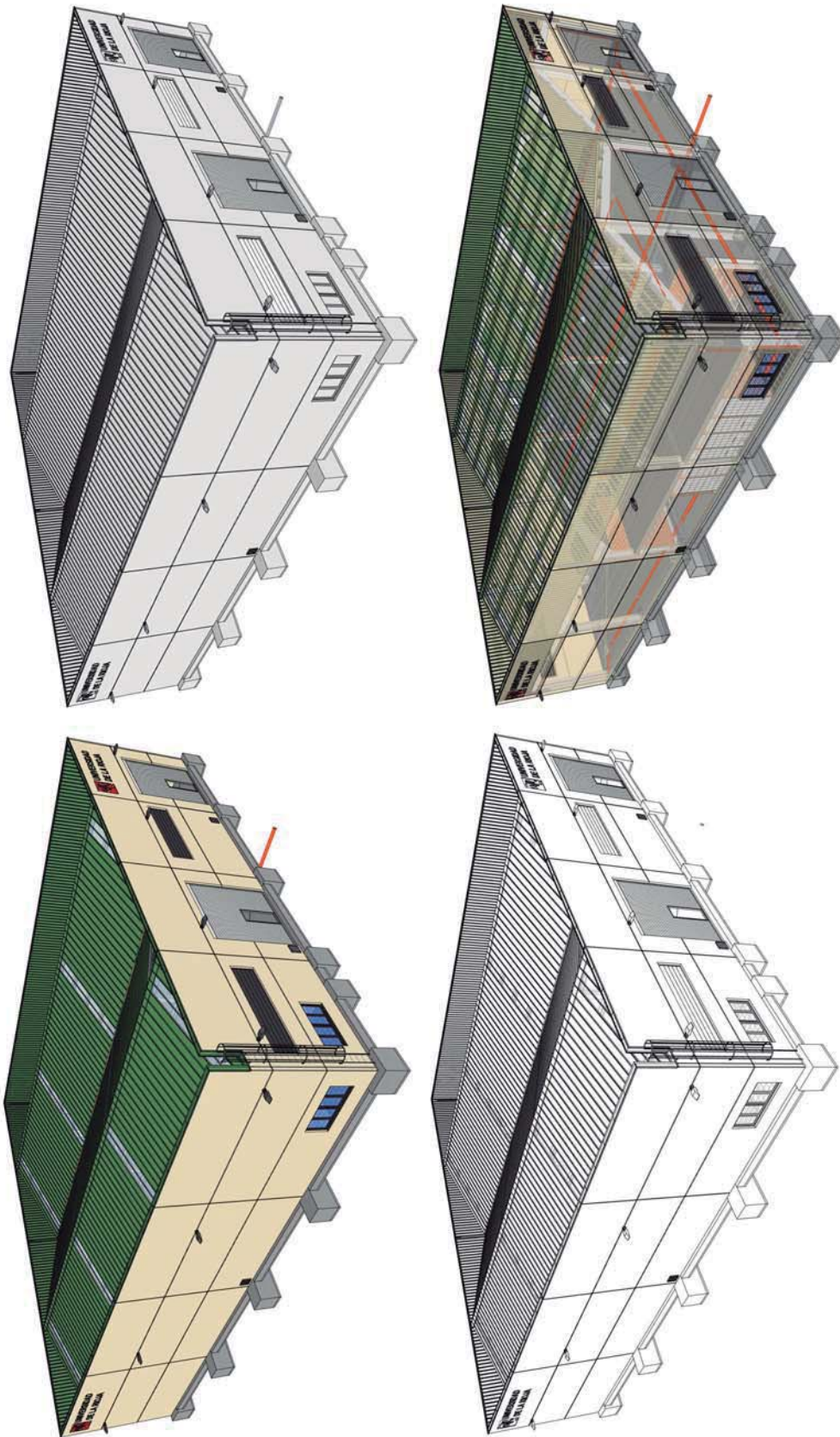
Fig. 3. 24- Diferentes estilos para mostrar el modelo. Sólido con texturas, monocromo, líneas ocultas y rayos X. Fuente: elaboración propia.
