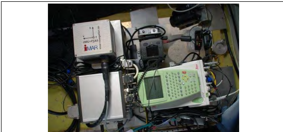
Figura 7. Sistema EROLASER montado en el interior de una avioneta para toma de datos LIDAR aéreo
