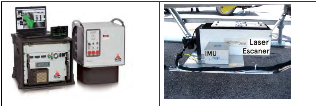
Figura 6. Componentes de un sistema para toma de datos LIDAR aéreo
