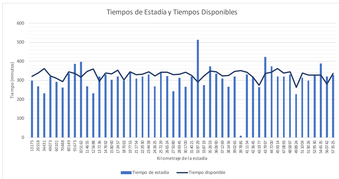
Figura 57 Mantenimiento oportunista: duración de las estadías con intervalos y tiempos de estadía variables
