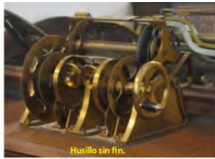
Husillo sin fin. Máquina analógica. L. Torres Quevedo (c. 1928).
