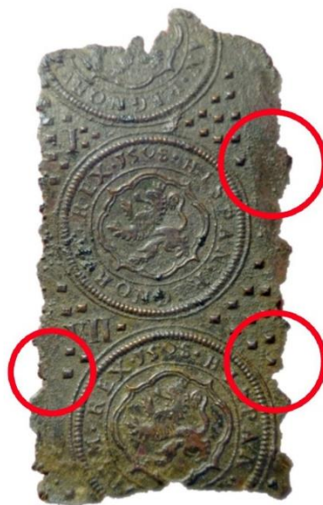
Foto 10. Laterales en forma de sierra por efecto de la expansión del metal. (Foto y diagramas del autor)
