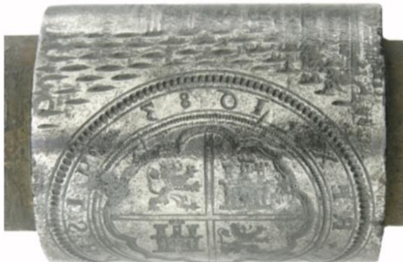
Foto 3. Rodillo de 1683 de Cincuentín del Real Ingenio de Segovia (Foto de Glenn Murray, Asociación de Amigos de la Casa de la Moneda de Segovia. MCM- 2493- 1004296).
