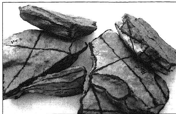
Fotografía 14. Muestras de Peñaportillo restauradas y finalizados los ensayos acelerados. Buen comportamiento de los sistemas piedra-producto. Los ciclos de hielo-deshielo no provocaron daños ni en la roca ni en las sustancias incorporadas en su reparación.
