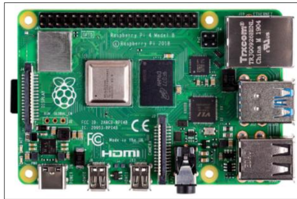
Figura 5. SBC Raspberry Pi4 Modelo B.
