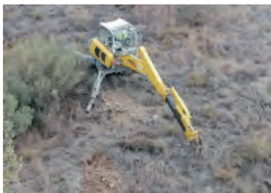
Figura 4. Retroaraña, diseñada para repoblaciones en terrenos con pendientes superiores al 30%.
