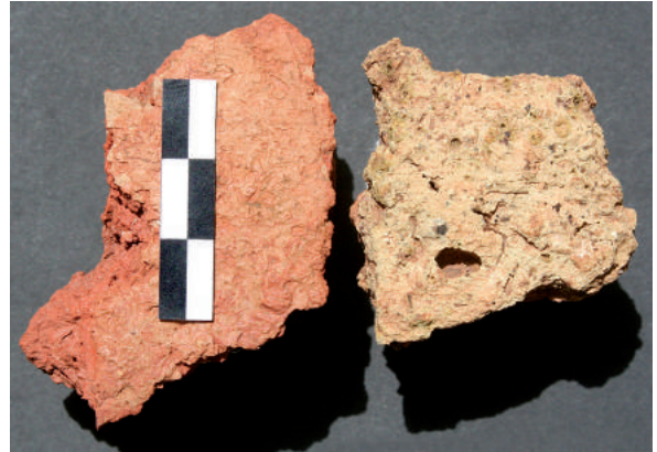
Fig. 21: Muestras de paredes de las cámaras de fuego de los hornos de barras HB-A (izquierda) y HB-B (derecha), con diferencias de color, tipo de inclusiones y textura.
