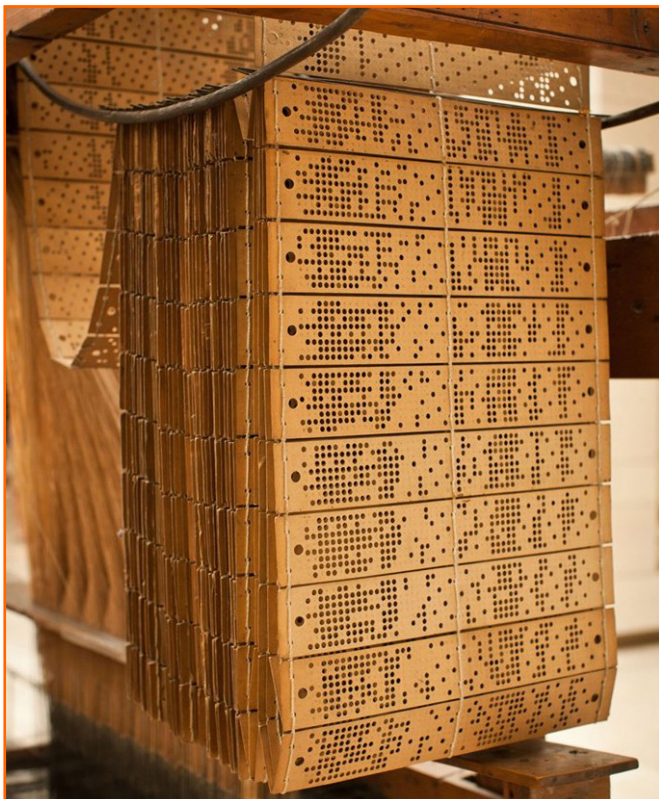
Figura 1. Tarjetas perforadas de telar Jacquard del siglo XIX, donde cada hilera de agujeros perforados corresponde a una hilera del textil que se está tejiendo Fuente: Museo nacional de Escocia. https://www.nms.ac.uk/explore-our-collections/stories/science-and-technology/jacquard-loom/
