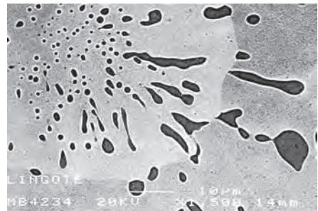
Glóbulos de sulfuro de cobre en una matriz homogénea de Cu, presentes en un lingote de fundición encontrado en Cerro Muriano.
