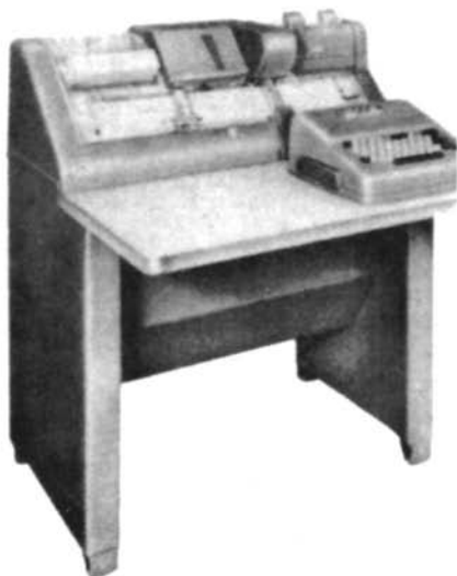
Figura 3. Perforadora-impresora de tarjetas IBM 26
