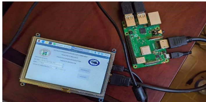
Figura 12. Conexión entre la Raspberry y la pantalla Touch.
