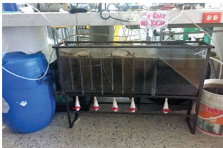
Figura 2. Montaje experimental del reactor flujo pistón (RFP)
