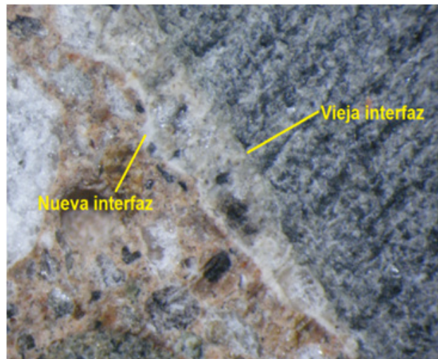
Figura 4. Vista de sección de la vieja y nueva ZTI del CAC 20 % RM con AGR Figura: elaboración propia.
