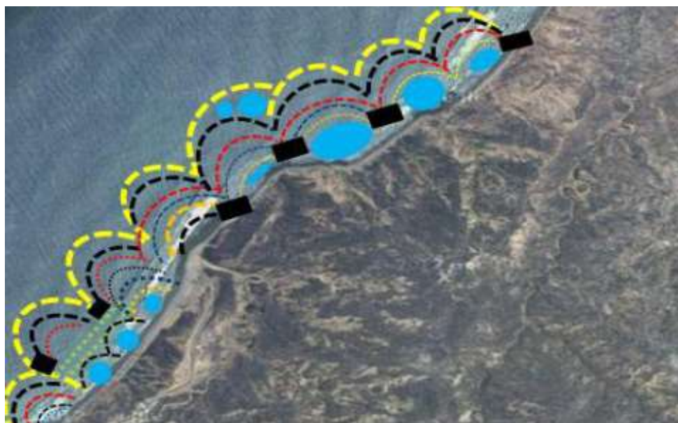
Figura 1 Diseño estructural de los corrales marinos en la comunidad de Ligüiqui
