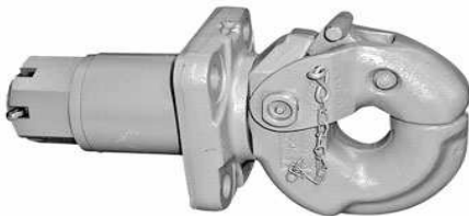
Figura 2. Acople para el enganche de semirremolques
