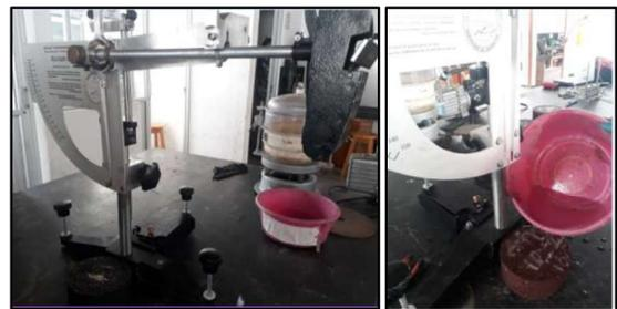
**Fig. 9. Ensayo de Coeficiente de deslizamiento con el péndulo británico.**
