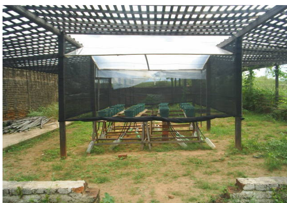
FIGURA 1. Casa de vegetação adaptada para os ensaios experimentais, como também visualiza a unidade experimental com detalhe para o dreno na parte inferior do vaso.
