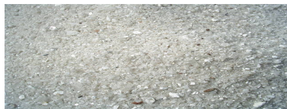
FIGURA 2. Rejeito de caulim usado no experimento após uniformização da granulometria em uma malha de 4 mm e submetido a uma lavagem de sete dias.
