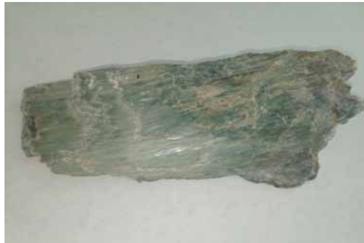
Figura 9. Zona de cizalla con relleno de serpentinitas y estrías de fricción.
