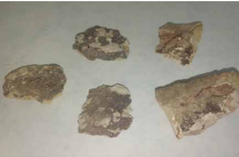
Figura 7. Pátina constituida por elementos del interior de la roca matriz.
