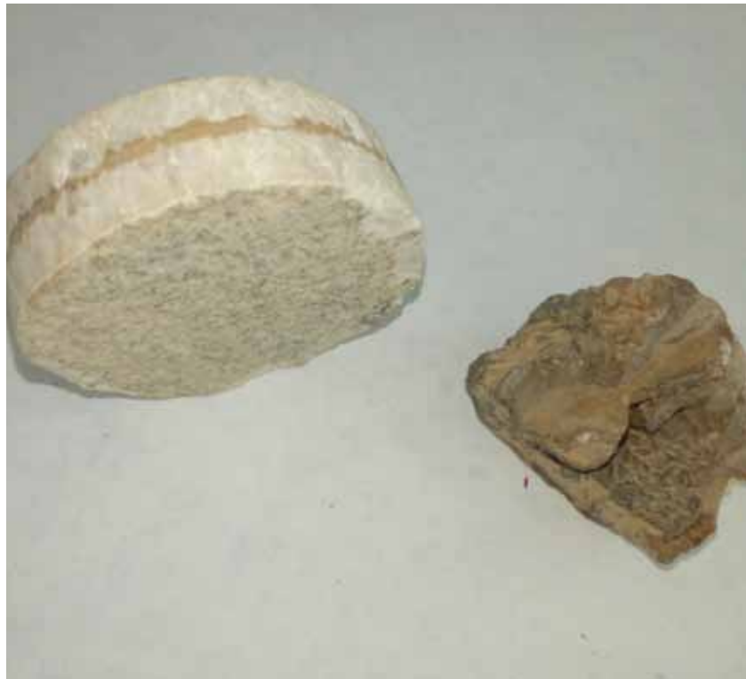
Figura 5. Costra o relleno formado por los minerales depositados.
