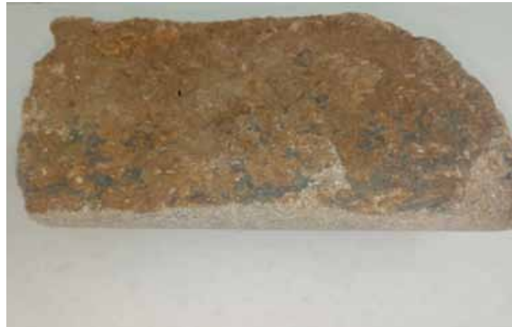
Figura 8. Pátina y costra, conjuntamente en la discontinuidad con escalones pre-rotura.
