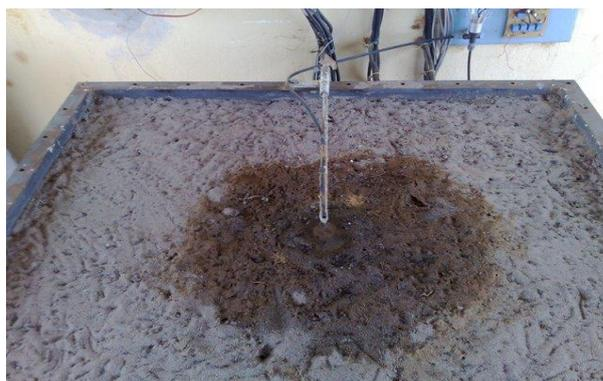
Figura 4. Detalhe da instalação do emissor e do bulbo molhado
