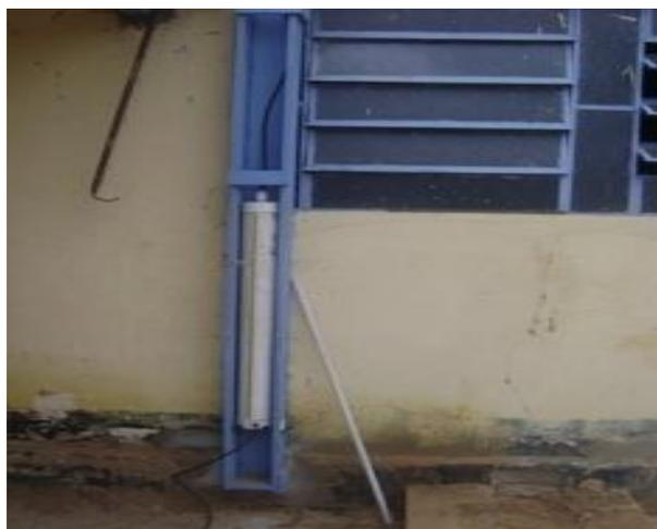
Figura 5. Vista do bulbo infiltrômetro e do suporte para variação da carga hidráulica
