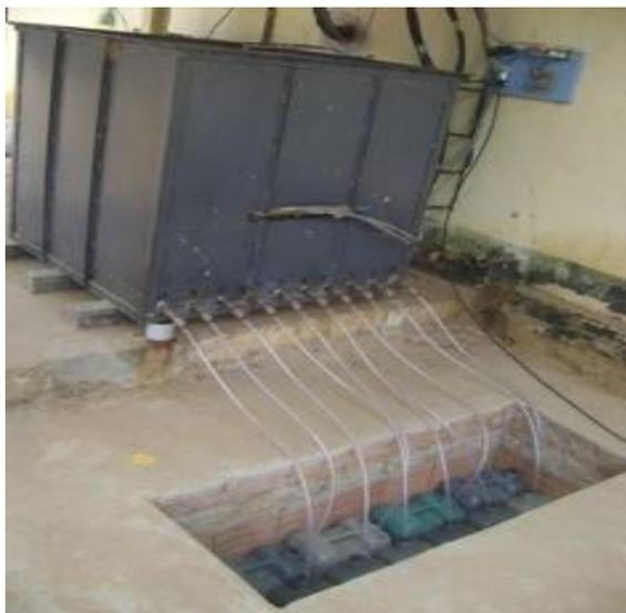
Figura 2. Detalhe do sistema de drenagem do lisímetro e dos coletores.
