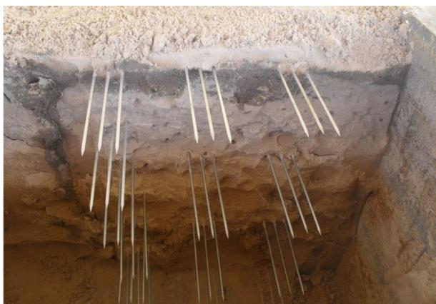
Figura 3. Corte com detalhes da instalação das sondas TDR
