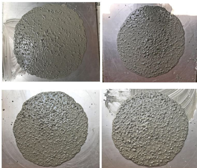
Figura 6. Ensayo de flujo de asentamiento mediante cono de Abrams, (de izquierda a derecha, mezcla patrón, F-10 %, F-20 %, F-30 %). Fuente: elaboración propia.
