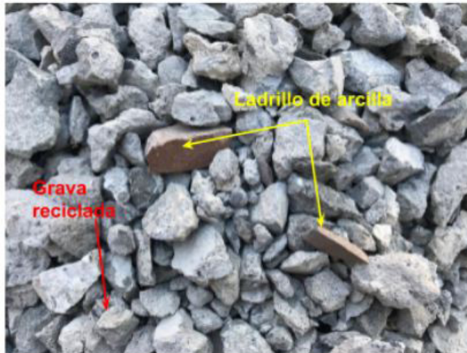
Figura 2. Concreto reciclado. Fuente: elaboración propia.
