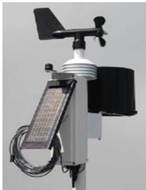
Fig. 1. Estación meteorológica PVMET-300 utilizada en la toma de datos. Fuente: autores.
