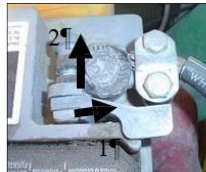
Fig. 3. Posicionamiento de terminal.
