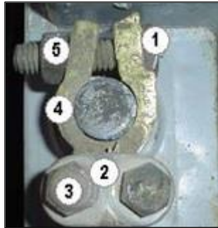
Fig. 1. Partes de la terminal de bronce: 1) Tornillo largo; 2) Lamina sujetadora; 3) Tornillo chico; 4) Cuerpo de terminal; 5) Tuerca del tornillo largo.
