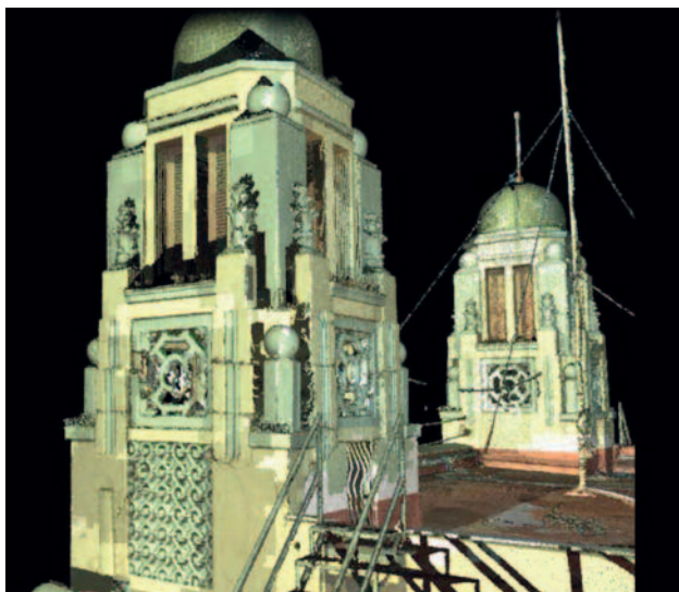
(Figura 1) Levantamiento de los torreones con escáner 3d.
