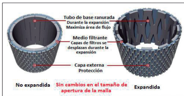
Figura 2. Malla Expandible (MOHD ISMAIL, I. y GEDDES, M). Modificado por los autores.
