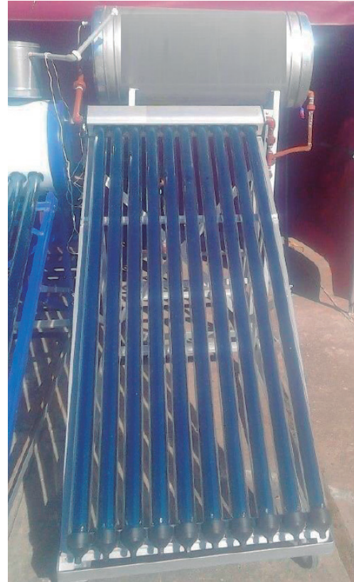
Figura 2. CSTE con tubo de calor (heat pipe).
