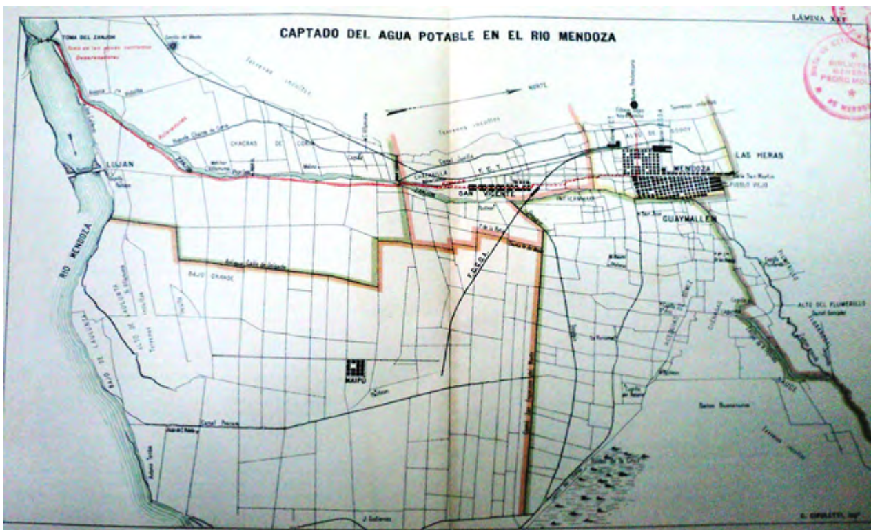
Plano efectuado por Chipolleti en 1896 donde se puede observar el captado de agua potable del Río Mendoza y la red hídrica consolidada en la provincia de Mendoza de fines del siglo XIX. Fuente: Emilio Coni. Imprenta Pablo Coni e hijos, 1897. Lámina XXI.
