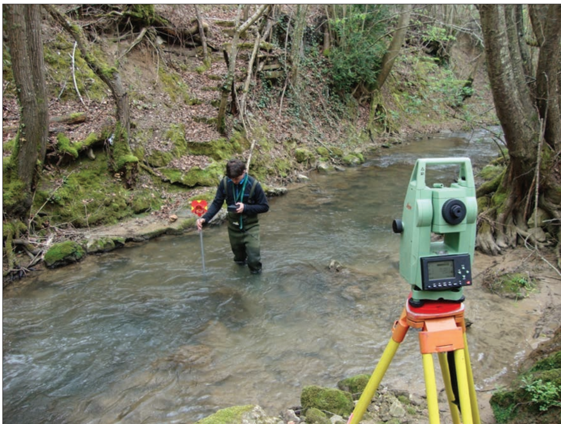
Figura 5. Medición de velocidad, tipo de sustrato y cota de la lámina de agua en uno de los puntos muestreados.
