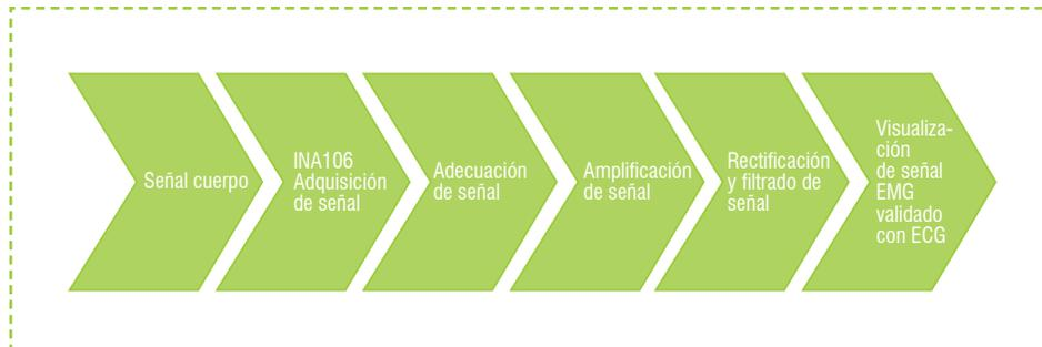
Figura 1. Fases del sistema básico de registro de señales EMG.
