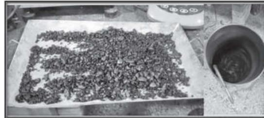
Figura 3. Mezclado de material MDC-19
