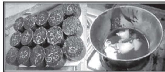
Figura 5. Densidad Bulk ( $G_{mb}$ ) MDC-19
