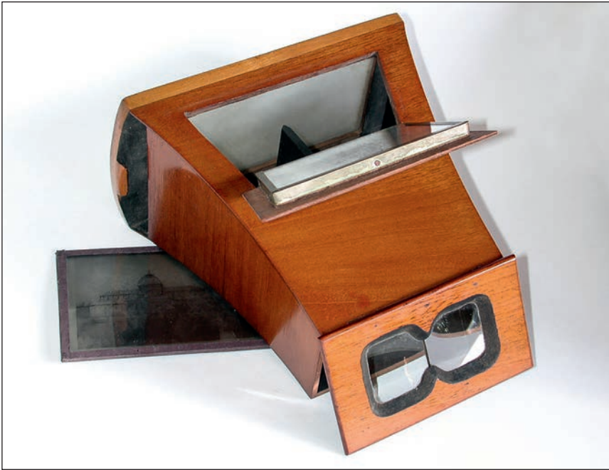
Visor estereoscópico tipo Brewster, década 1860. Adaptado para la visualización tanto de cartulinas como de estereoscopias sobre cristal.
