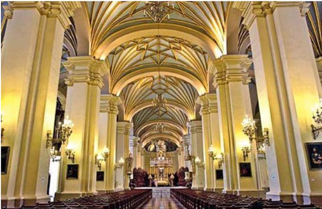
(Figura 9) Nave central de la catedral de Lima. El material más ampliamente usado en la construcción de las bóvedas es la madera y la quincha (especie de adobe con alma de caña), al objeto de evitar los daños que los frecuentes terremotos producen en la mampostería convencional.
