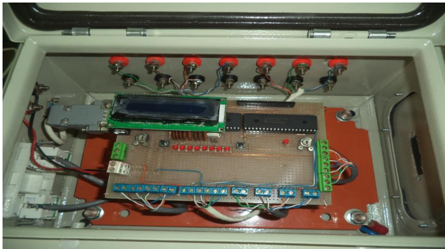
FIGURA No. 7. TARJETA PARA COMUNICAR LAB WIEV CON EL MICROCONTROLADOR. Elaboración: Los autores.
