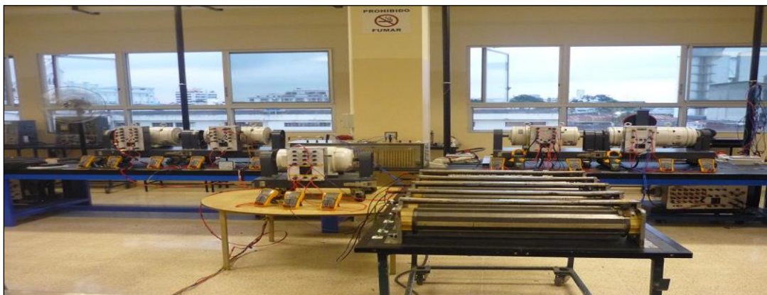
FIGURA No. 2. SISTEMA DE DISTRIBUCION DC FORMADO POR DOS GRUPOS MOTOR-GENERADORES DC. Fuente: Laboratorio de La Universidad Politécnica Universidad Politécnica Salesiana
