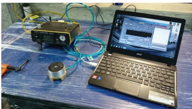
Figura 3. Ejemplo de equipo PATTI y resultados del ensayo.
