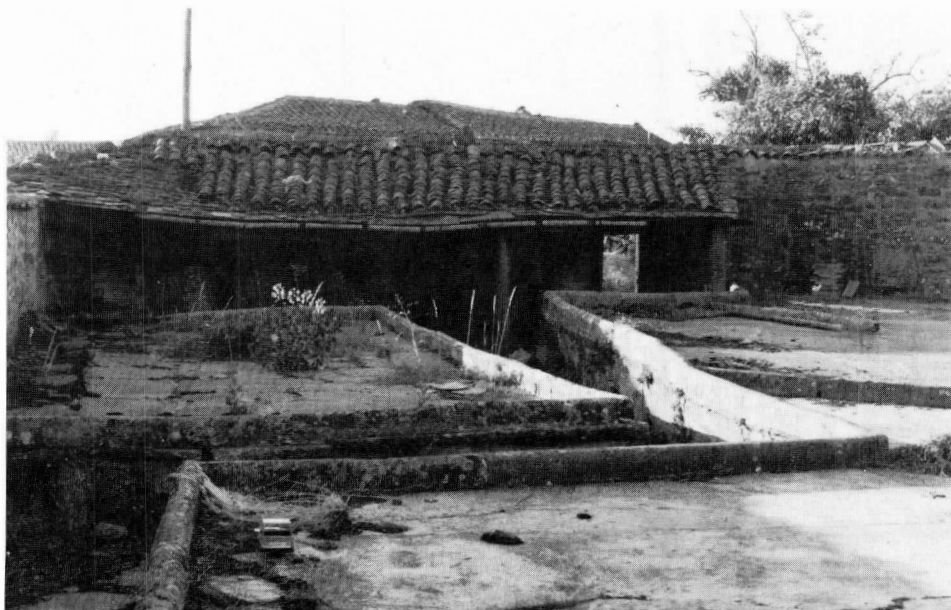
Fot. 4.—Vista parcial de las planchas donde se extiende la cera para blanquearla.
