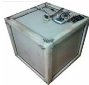
Figura 5 Cámara para Curado de Concretos Fuente: Autor
