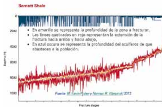
Fig. 9. Control de la fracturación.
