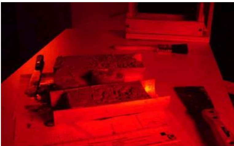
Figura 5. Ejemplo de una muestra abierta dentro del laboratorio oscuro. El núcleo seleccionado se muestra con los bordes removidos.
