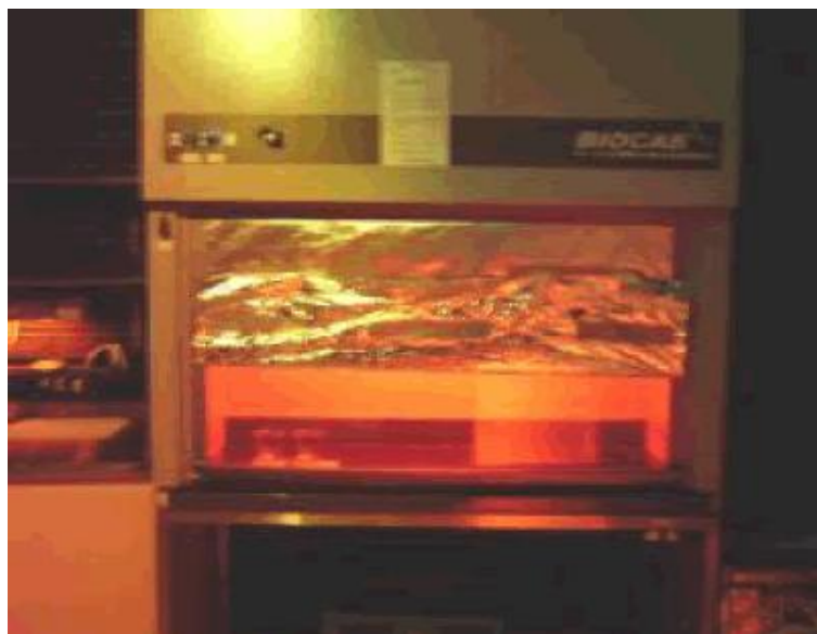
Figura 7. Campana extractora de gases
