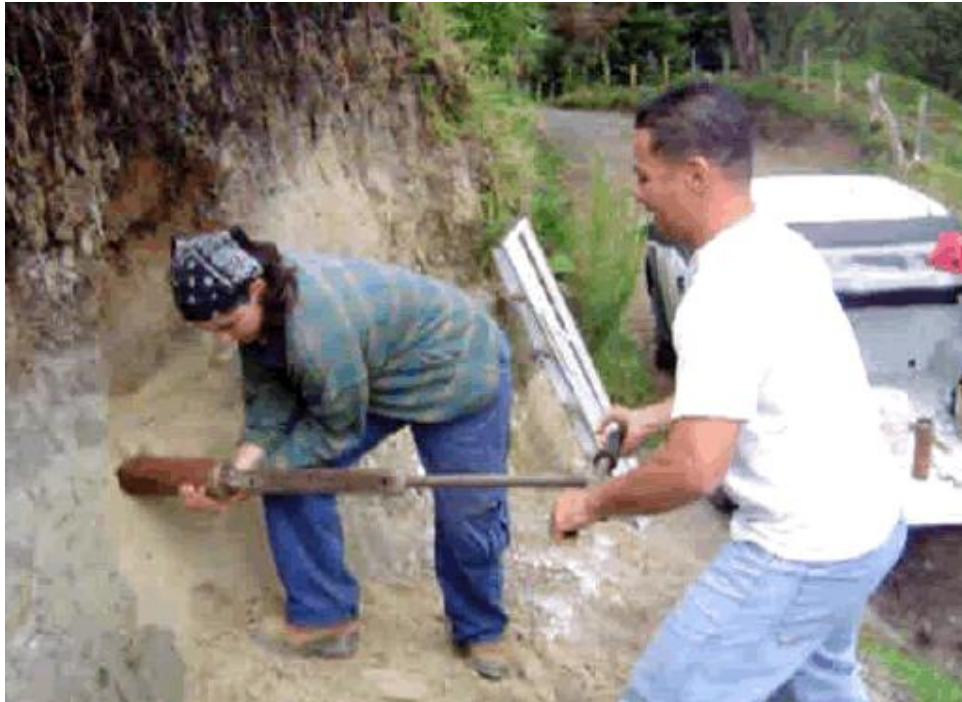
Figura 4. Toma de muestras para fotoluminiscencia utilizando el aparato percutor. Debido al alto grado de compactación general de la muestra, es necesario la participación de al menos dos personas en le proceso de extracción.
