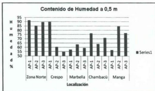
Figura 3. Contenido de Humedad muestras recuperadas a 0.5 m de profundidad
