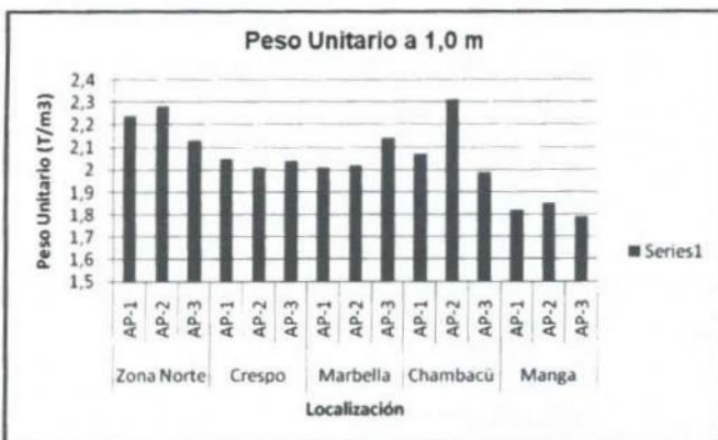
Figura 6. Peso Unitario muestras recuperadas a 1.0 m de profundidad
