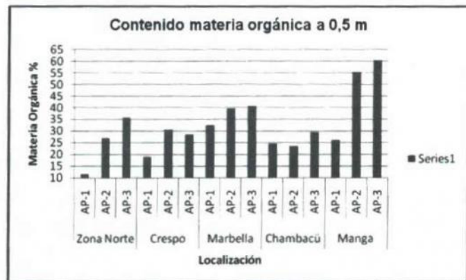
Figura 7. Contenido de materia orgánica de muestras recuperadas a 0.5 m de profundidad
