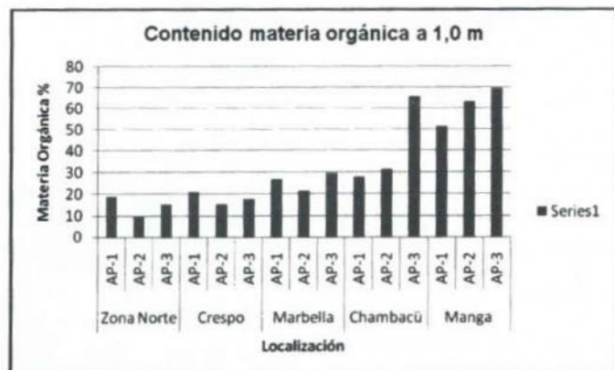
Figura 8. Contenido de materia orgánica de muestras recuperadas a 1.0 m de profundidad
