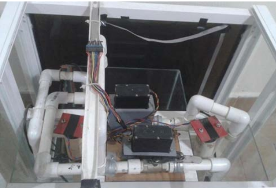
FIGURA 3. Vista superior del prototipo de tanques acoplados construido por estudiantes de ingeniería en Mecatrónica.
