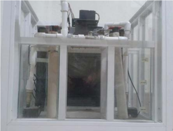
FIGURA 2. Vista frontal del prototipo de tanques acoplados construido por estudiantes de ingeniería en Mecatrónica.
