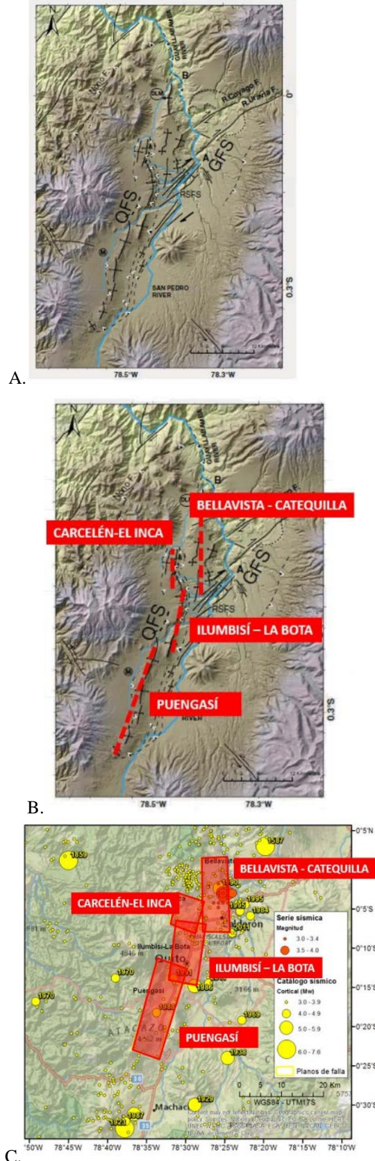
Figura 1. A. Nuevo mapa neotectónico de la ciudad de Quito. B. Longitud de superficie de ruptura. C. Plano de falla. Fuente: A. B. [6] C. [18]
