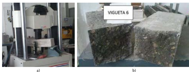
Figura 3. Ensayo a flexión con carga en el centro de la luz. a) Montaje de las viguetas, b) Caras de una superficie de falla (agregado reciclado)
