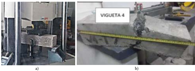
Figura 5. Ensayo a flexión con cargas a los tercios de la luz. a) Montaje de las viguetas, b) Falla típica del concreto adicionado con fibras de acero.
