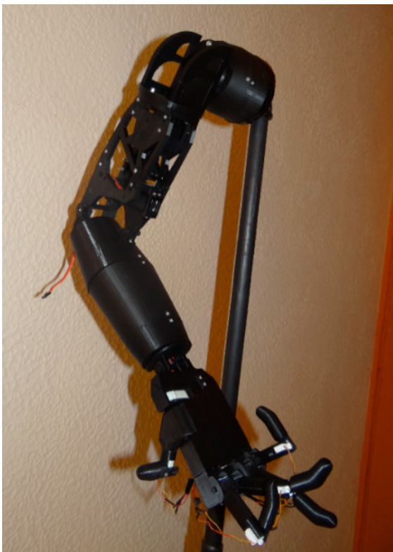
Fig. 11. Brazo impreso en PLA negro Fuente: Autores.
