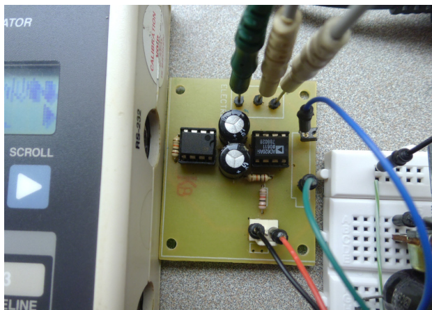
Figura 7. Etapa de amplificación de señal ECG.
